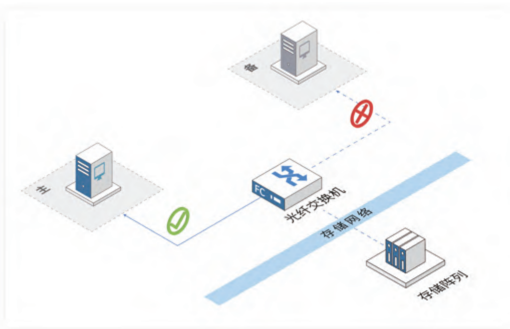
图 1：共享存储架构
