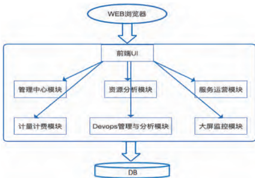
图 1：云管理平台改造前部署架构图
