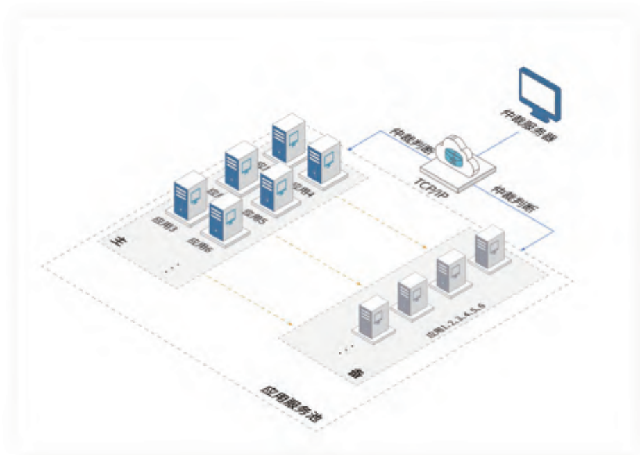
图 7：仲裁服务器架构图
